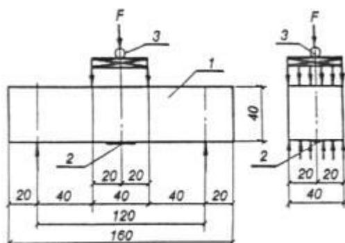
1 - опытный образец; 2 - тензорезистор базой 20 мм;
